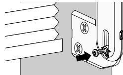
8. Asegúrese de que el cable pueda moverse libremente a través del UCT sin engancharse en el cierre. El centro del orificio del tornillo debe estar alineado con la muesca del UCT ( $\pm\frac{1}{8}$ ").
