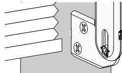
c. Inserte el pequeño tornillo suministrado en el saliente por la parte delantera del orificio del tornillo y apriételo para fijar el UCT al soporte.
