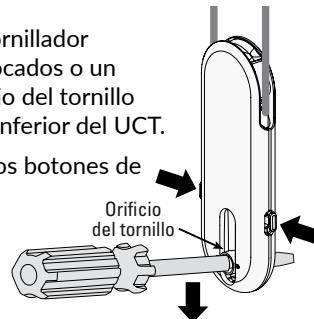
2. Mientras presiona los botones de liberación del UCT situados a los lados del UCT, mueva el orificio del tornillo hacia abajo para liberar el mecanismo de seguridad.
