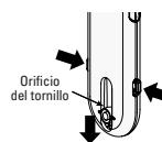
b. Inserte el saliente del soporte de montaje interior en la parte posterior del orificio del tornillo del UCT.
