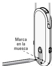
4. Sujete el soporte IB con el orificio central alineado con la marca y marque la posición de ambos orificios.
